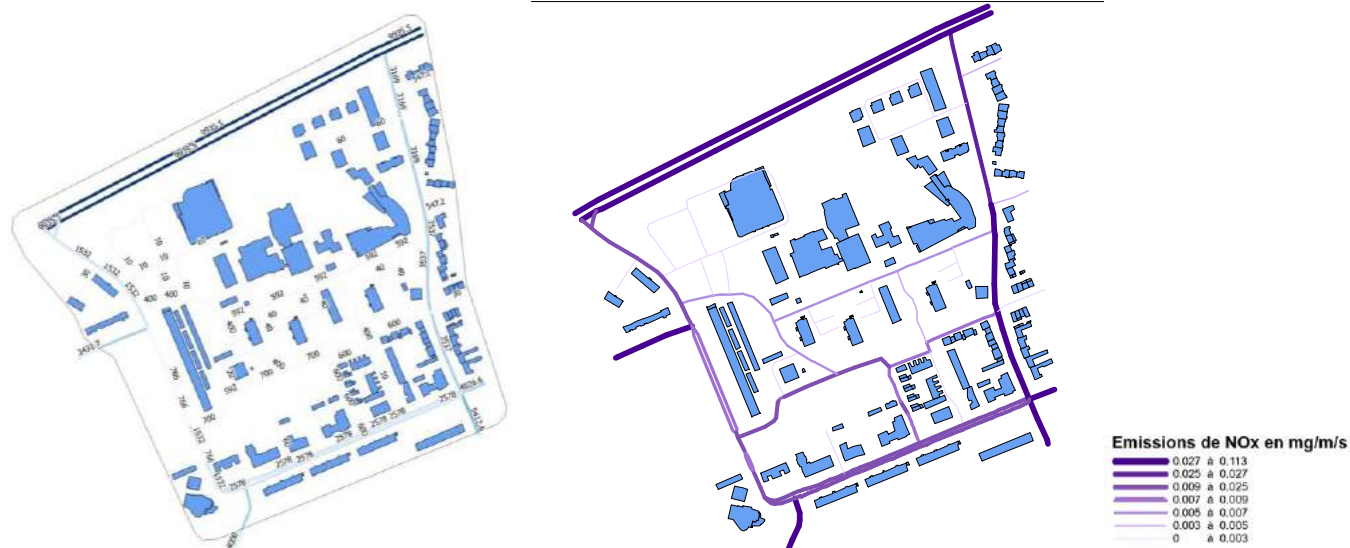
Sources routières et leur trafic moyen journalier annuel (à gauche), et estimation des rejets d'oxydes d'azote NOx (à droite).
