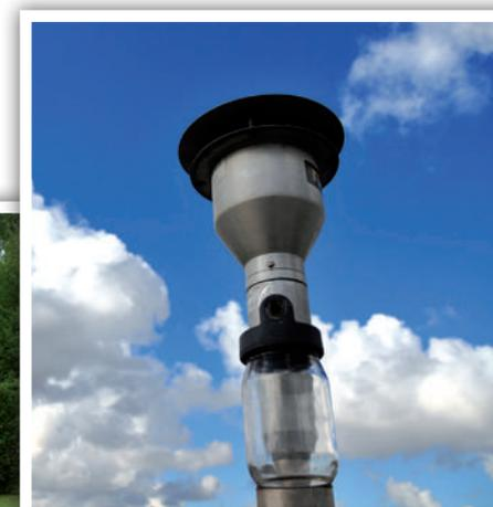
Tête de prélèvement d'un échantillon d'air
