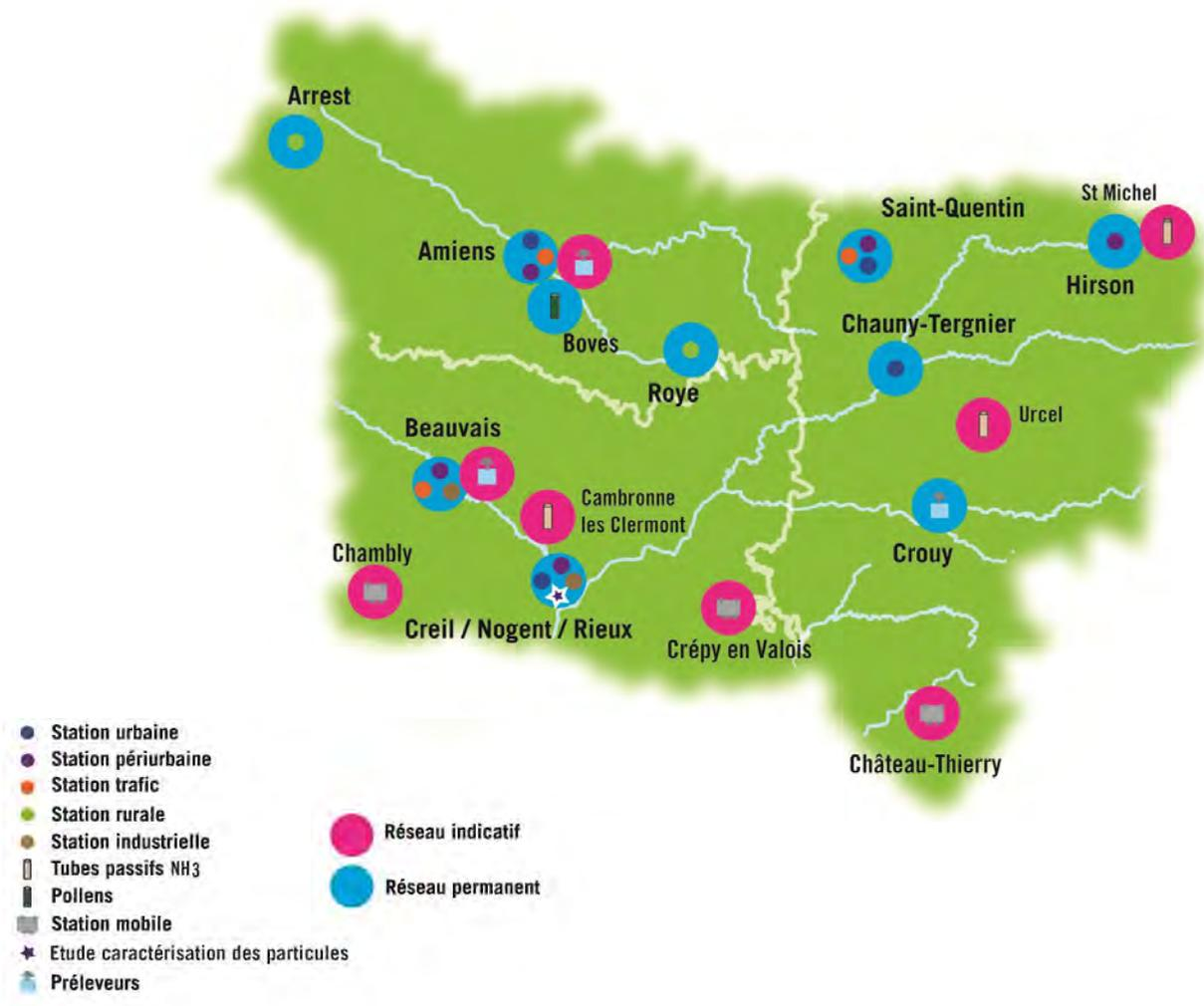
En 2015, le réseau permanent est constitué de 16 stations fixes et d'un capteur de pollens.
