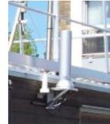
Sonde SpectroTracer de mesure de la radioactivité à Malo-les-Bains
