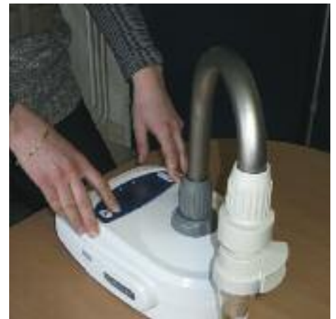
Prélèvement d'air à l'air du Coriolis
