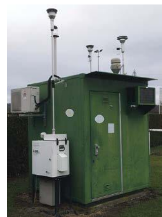
Dispositif de l'étude spéciation des particules
