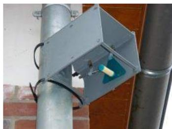
**Principe** : l'air passe à travers un tube par simple diffusion moléculaire et le polluant est piégé sur un milieu absorbant. Il est analysé dans un second temps en laboratoire. Les tubes peuvent être installés sur une station fixe ou mobile, ou indépendamment.
