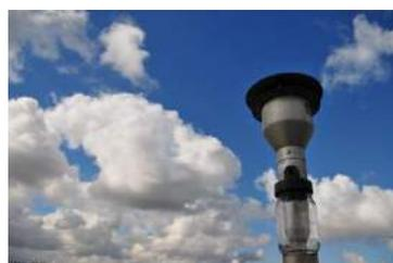
**Principe** : le préleveur est une pompe qui aspire continuellement l'air. Les polluants sont piégés au passage de l'air par un système de filtration. Ce support est ensuite analysé en laboratoire. La plupart du temps, ces préleveurs sont installés en station fixe ou mobile.
