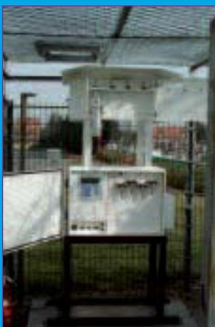
L'échantillonnage est réalisé sur une semaine sur un préleveur moyen débit (1 m<sup>3</sup>/h), le Partisol Spéciation. L'air est aspiré par le préleveur et passe à travers un filtre et une mousse, sur lesquels les pesticides sont piégés.
