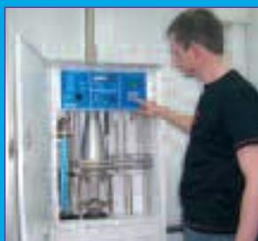
L'échantillonnage est réalisé pendant 48 heures avec un préleveur haut débit (30 m<sup>3</sup>/heure) sur filtre. Le prélèvement s'effectue tous les 6 jours. Les filtres exposés sont stockés dans des boîtes de Pétri, enveloppées d'aluminium. L'analyse des HAP est réalisée en laboratoire, après extraction par le cyclohexane (solvant) et au moyen d'une chromatographie en phase liquide couplée à une détection fluorimétrique.
