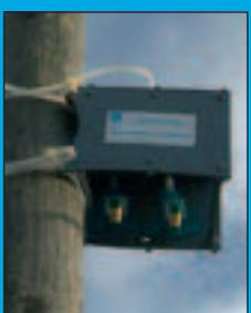
Le pas de temps des mesures en quart-heure permet ensuite le calcul des moyennes horaires et annuelles. Afin de caractériser la pollution par le benzène à l'échelle d'une agglomération, une autre technique de mesure est utilisée. Il s'agit des tubes à diffusion passive. Une fois exposée, la cartouche est envoyée au laboratoire pour analyses (voir glossaire).
