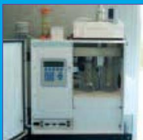
L'échantillonnage est réalisé sur une semaine à l'aide d'un préleveur au débit de 1 m<sup>3</sup>/h (le Partisol Plus). L'air est aspiré par le préleveur et passe à travers un filtre, sur lequel les métaux sont piégés.
