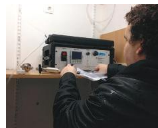
Installation d'un préleveur pour la mesure des perturbateurs endocriniens en air ambiant
