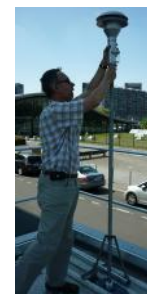
Compteur de particules ultrafines (UFP 3031) installé à Lille-Leeds (à gauche) et installation de la tête de prélèvement de la station sur le toit de la station (à droite) © Atmo Hauts-de-France
