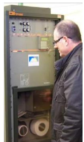
Ancienne balise de surveillance de la radioactivité utilisée par atmo jusqu'en 2014
