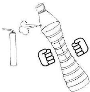
Si nous plongeons la bouteille dans l'eau, cet écrasement fait apparaître des bulles d'air qui s'échappent du trou et viennent éclater à la surface. Voilà donc le secret de la résistance d'une bouteille bouchée : cet air prisonnier s'oppose à son écrasement.
