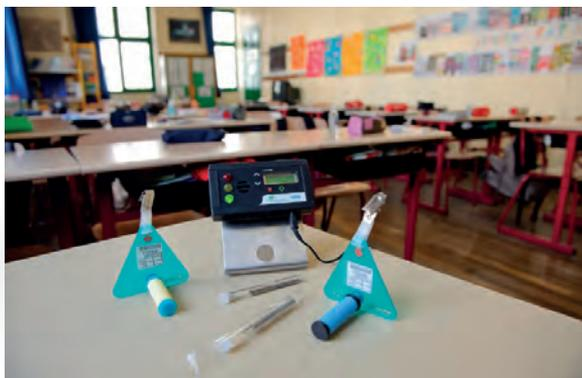
Dans ta classe, la qualité de l'air peut être surveillée à l'aide de boîtiers qui mesurent la **quantité de dioxyde de carbone** dans l'air :
