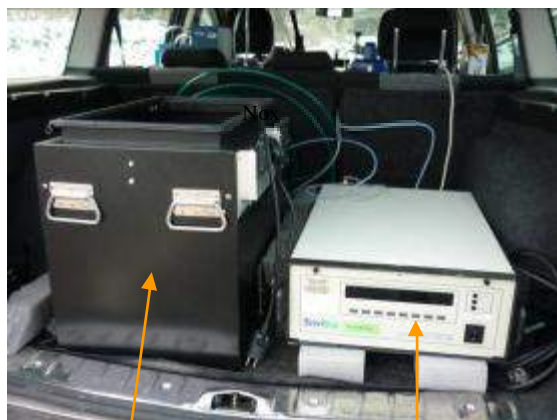
Batteries Analyseur d'oxydes d'azote
