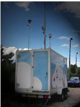
Les stations mobiles sont constituées d'un véhicule tracteur et d'une remorque, ou bien d'un véhicule type fourgonnette. Elles sont équipées d'analyseurs de différents polluants et de capteurs spécifiques aux paramètres météorologiques. Ces stations sont les mêmes que les autres stations fixes du réseau, à cette différence près qu'elles sont, comme leur nom l'indique, adaptées au déplacement.
