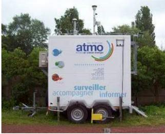
stations mobiles – polluants mesurés : dioxyde de soufre, oxydes d'azote, particules en suspension PM10 et composés organiques volatils dont les BTEX (benzène, toluène, éthylbenzène et xylènes).
