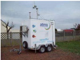
stations mobiles – polluants mesurés : dioxyde de soufre, oxydes d'azote, ozone, particules en suspension PM10
