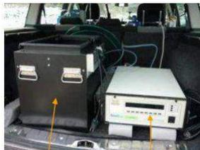
Batteries    Analyseur d'oxydes d'azote
