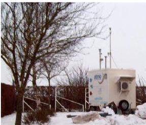
**Hoymille** (2013) : 2 phases de 4 et 5 semaines, dioxyde de soufre, oxydes d'azote, ozone, particules en suspension
