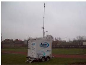
**Bailleul** (2011) : 2 phases de 4 et 5 semaines, dioxyde de soufre, oxydes d'azote, ozone, particules en suspension
