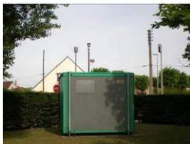
Sur le site de **Saint-Pol-sur-Mer**, ont été surveillés les particules en suspension PM10, les oxydes d'azote, ozone et le dioxyde soufre. Les concentrations de l'ensemble de polluants sur les périodes de mesures sont représentatives du niveau de fond urbain et sont similaires à celles mesurées au niveau de la station fixe.
