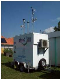
**Wimereux** (2012) : 2 phases de 4 et 5 semaines, dioxyde de soufre, oxydes d'azote, ozone, particules en suspension
