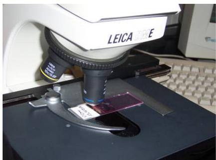
*Installation des lames sur le microscope*
