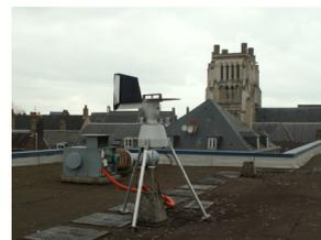
Les pollens aspirés sont impactés sur des bandes de cellophane imprégnées d'une solution à base de silicone (ce qui permet de fixer les grains de pollens), elles-mêmes placées sur un tambour qui effectue une rotation d'une semaine grâce à une horloge interne. Les bandes ainsi récupérées sont alors :
