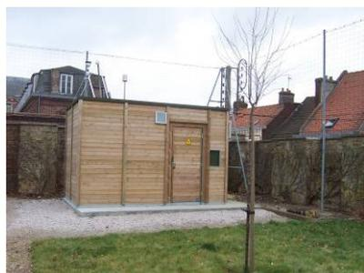
**atmo** Nord - Pas-de-Calais dispose d'une station fixe dans la cour du lycée Ribot de Saint-Omer consacrée à la mesure en continu des principaux polluants indicateurs de la qualité de l'air physico-chimiques.
