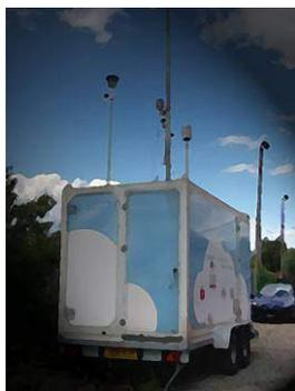
Les 3 stations mobiles sont constituées d'un véhicule tracteur et d'une remorque, ou bien d'un véhicule type fourgonnette. Elles sont équipées d'analyseurs de différents polluants et de capteurs spécifiques aux paramètres météorologiques. Ces stations sont les mêmes que les autres stations du réseau, à cette différence près qu'elles sont, comme leur nom l'indique, adaptées au déplacement.
