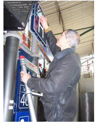
Installation du matériel de mesure « tubes passifs »
