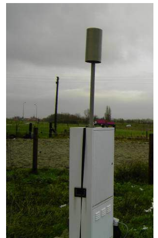
Figure 12 : Préleveur DA 80 sur le site P4
