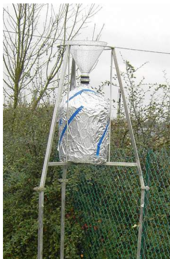
Figure 13 : Collecteur de retombées sur le site P2
