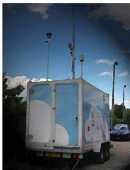
Les 3 stations mobiles sont constituées d'un véhicule tracteur et d'une remorque, ou bien d'un véhicule type fourgonnette. Elles sont équipées d'analyseurs de différents polluants et de capteurs spécifiques aux paramètres météorologiques. Ces stations sont les mêmes que les autres stations du réseau, à cette différence près qu'elles sont, comme leur nom l'indique, adaptées au déplacement.
