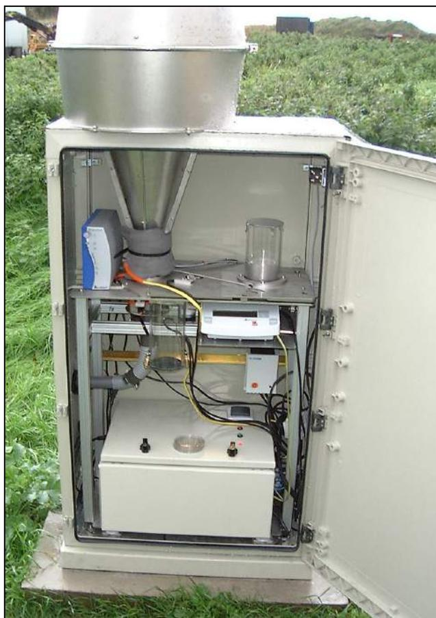
Figure 2 : Préleveur ADA MASS de poussières sédimentables installé à la station Fort-Mardyck
