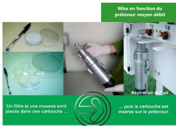
Figure 6 : Mise en place des supports de prélèvements sur le préleveur
