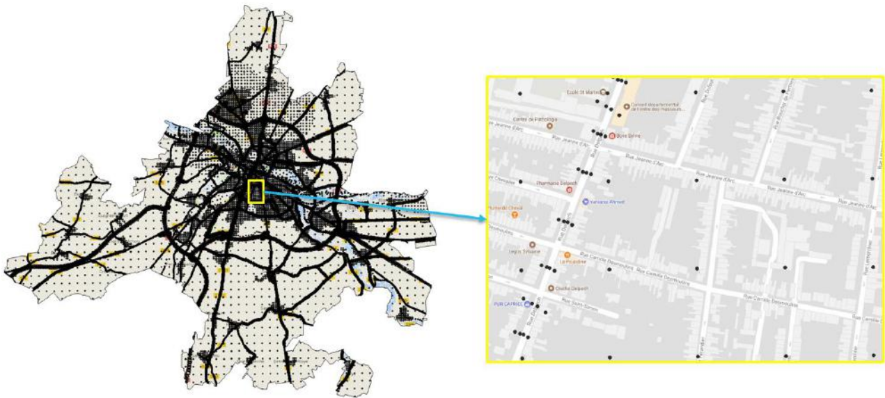
Figure 35 : Maillage utilisé pour le modèle urbain d'Amiens Métropole : à gauche, une vue d'ensemble sur le périmètre de l'agglomération ; à droite, un zoom sur le centre-ville d'Amiens, qui permet d'identifier à la fois un maillage régulier et divers points placés en proximité d'un axe routier.
