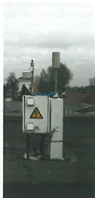
Figure 11 : Préleveur DA 80 sur le site de Grande-Synthe
