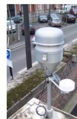
*Photo 5: Tête de prélèvement en proximité automobile*
