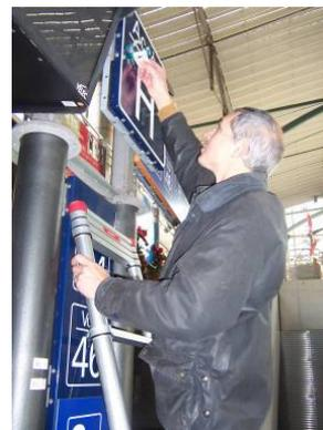
Installation du matériel de mesure « tubes passifs »
