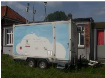
Ces mesures sont effectuées par des appareils électroniques, qui fournissent les concentrations des polluants 24h/24h, quart d'heure par quart d'heure. Ces méthodes permettent de suivre en temps réel les concentrations en polluants Ps, CO, NO<sub>2</sub>, SO<sub>2</sub> et d'identifier d'éventuels pics de pollution. Elles nécessitent l'installation de matériels assez encombrants et d'une alimentation électrique.
