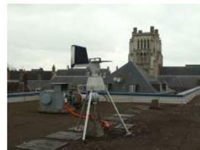
Les pollens aspirés sont impactés sur des bandes de cellophane imprégnées d'une solution à base de silicone (ce qui permet de fixer les grains de pollen), elles-mêmes placées sur un tambour qui effectue une rotation d'une semaine grâce à une horloge interne. Les bandes ainsi récupérées sont alors :
