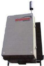
Ces mesures sont effectuées par des appareils électroniques qui fournissent les concentrations des polluants 24h/24h, selon un pas de temps défini de 10 secondes à 15 minutes. Ces mesures permettent de suivre en temps réel les concentrations en polluants PM<sub>10</sub>, PM<sub>2,5</sub>, CO, NO<sub>x</sub> et SO<sub>2</sub>, et d'identifier d'éventuels pics de pollution. Elles nécessitent l'installation de matériels assez encombrants et une alimentation électrique.
