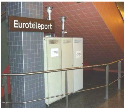
Mesures du  $SO_2$ , des  $NO_x$ , du  $CO$ , des  $PM_{10}$  et  $PM_{2,5}$ , des métaux lourds, et des paramètres de confort (température, humidité relative, teneur en  $CO_2$ ) sur le quai de la station Eurotéléport.
