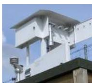
**1. le prélèvement** : l'air est aspiré pendant une semaine avec un préleveur, et les pesticides sont piégés sur un filtre (pour la phase particulaire) et une mousse (pour la phase gazeuse) ;
