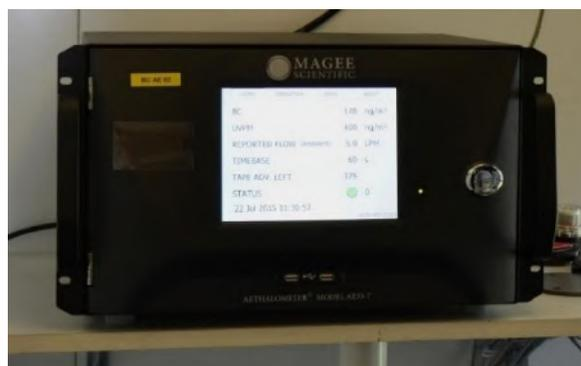
Figure 1 Photo de l'aéthalomètre modèle AE33 (source : Atmo HdF)
