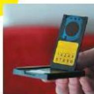
**A. Démarrez la mesure en ouvrant le boîtier** et en poussant doucement le couvercle vers l'arrière jusqu'à ce que vous sentiez un déclic de verrouillage. Le boîtier reste alors ouvert, couvercle légèrement incliné vers l'arrière, petit film plastique rouge à l'air libre. Chaque dosimètre est identifié par un numéro et un code barre
