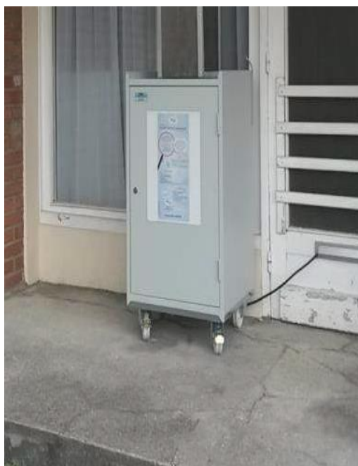
Figure 1 : Exemple de préleveur utilisé pour la mesure des perturbateurs endocriniens
