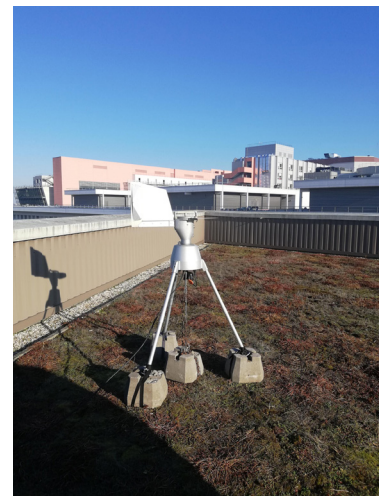
Capteur pollens installé sur le toit du CURS à Amiens
