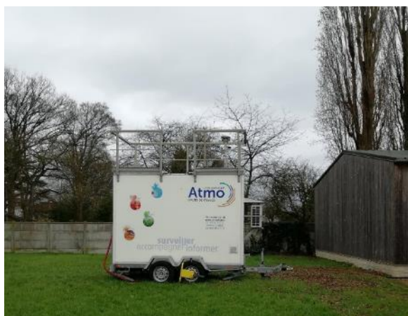
Station mobile de mesure installée à Chaumont-en-Vexin
