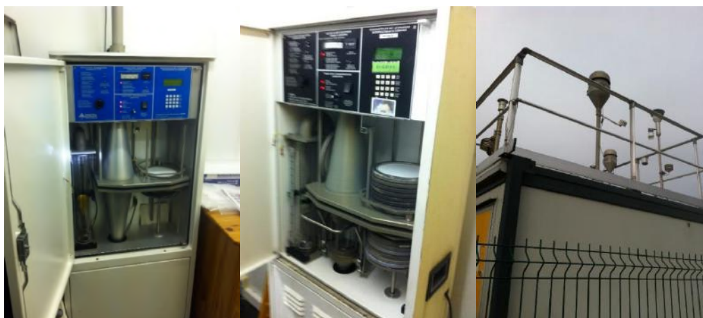
Photos de préleveurs DA80 (intérieur et tête de prélèvement)
