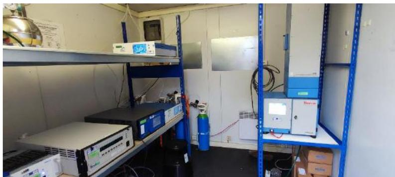
Les **oxydes d'azote** sont ainsi analysés dans l'air ambiant par chimiluminescence (norme NF EN 14211). Pour les **particules (PM10 et PM2.5)**, les méthodes utilisées (conformes à la NF EN 16450) sont équivalentes à la méthode de référence par pesée gravimétrique (normes NF EN 12341 pour les PM10 et NF EN 14907 pour les PM2.5). Ces méthodes sont :
