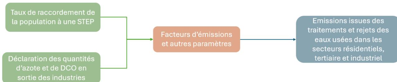
Figure 41 : Méthodologie de calcul de l'activité « traitement et rejets des eaux usées dans les secteurs résidentiel, tertiaire et industriel » du sous-secteur Traitement des déchets (les données d'activité en vert, le module de calcul en orange et les sorties attendues en bleu).
