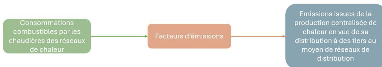
Figure 18 : Méthodologie de calcul de l'activité « chaleur urbaine » du secteur extraction, transformation et distribution d'énergie (les données d'activité en vert, le module de calcul en orange et les sorties attendues en bleu).
