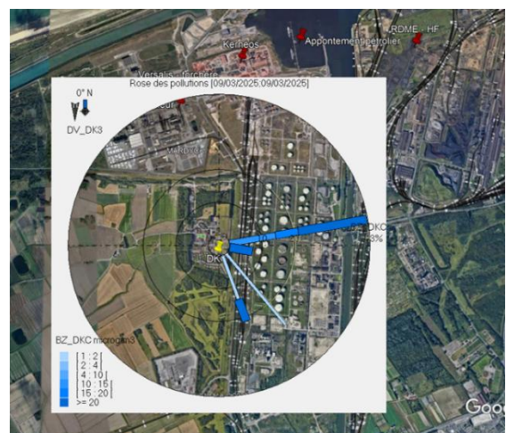
Figure 15 : profil en benzène et toluène du 9 mars 2025 et rose de pollution du benzène sur la station de Mardyck
